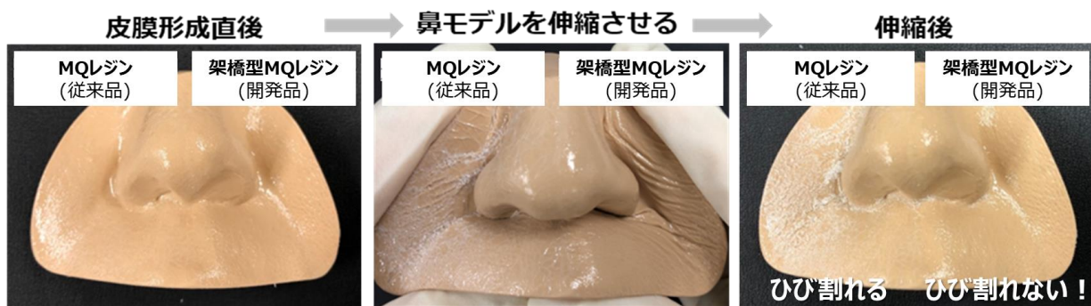
図1 開発した「架橋型 MQ レジン」の動きに対するヨレ評価
