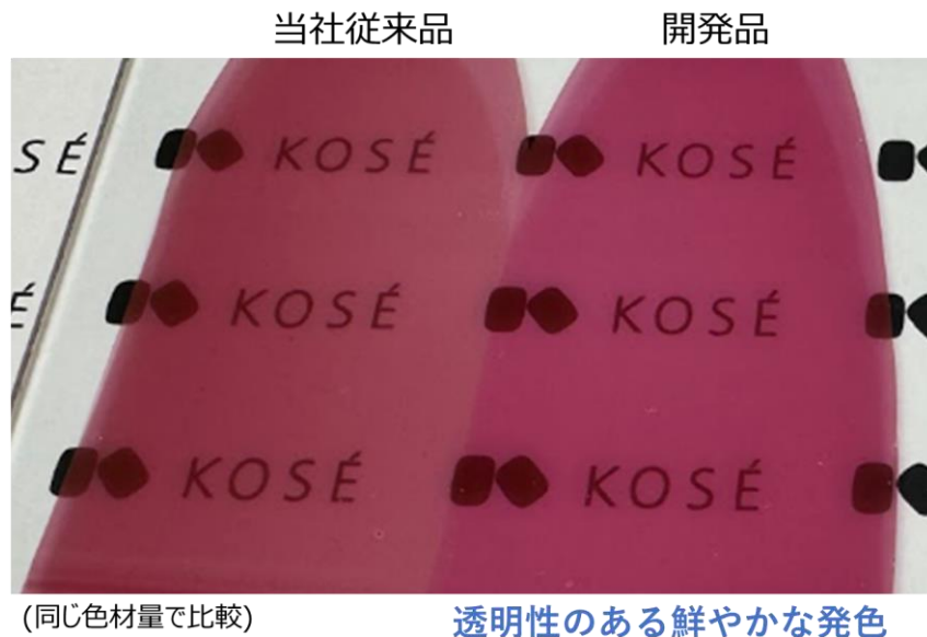
図1 開発した分散技術を用いた口紅の彩度(色の鮮やかさ)と透明性の評価
